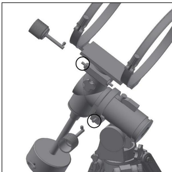
Figura 8. Posizionare le manopole di regolazione fine.
