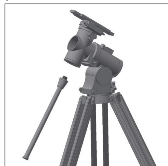
Figura 5. Infilare l'albero del contrappeso.
