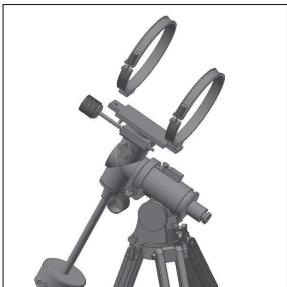
Figura 7. Posizionare gli anelli del tubo.
