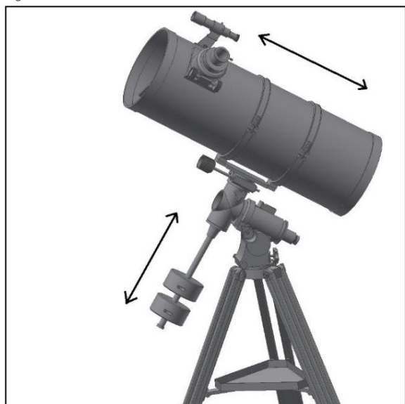
Figura 14. Bilanciare il telescopio.
