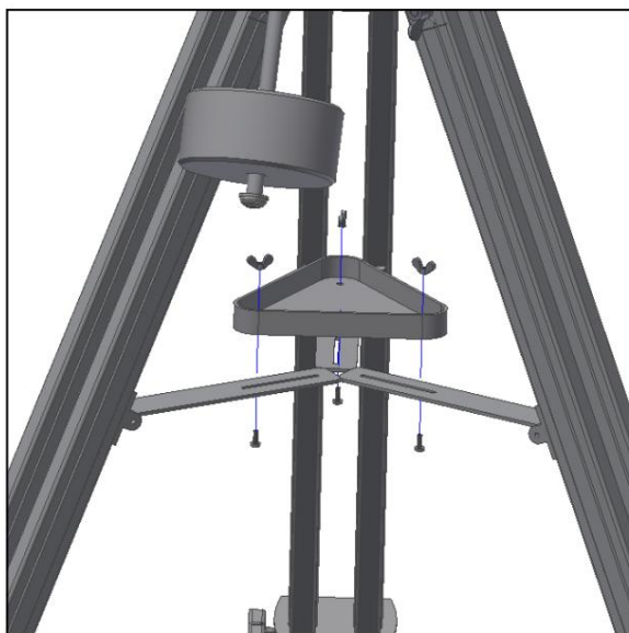
Figura 3. Posizionamento del vassoio.
