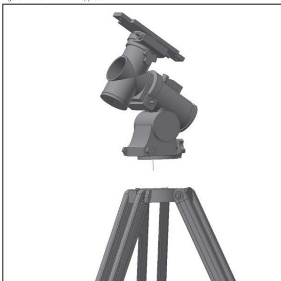
Figura 4. Posizionare la montatura equatoriale.
