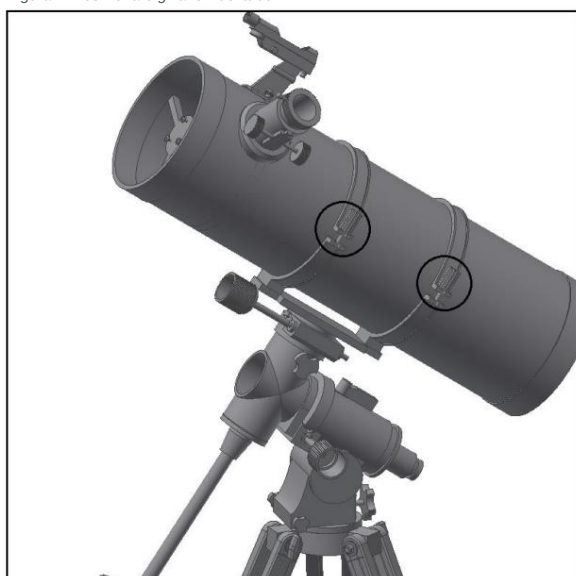
Figura 9. Far scorrere il tubo e avvitare le manopole ad anello.
